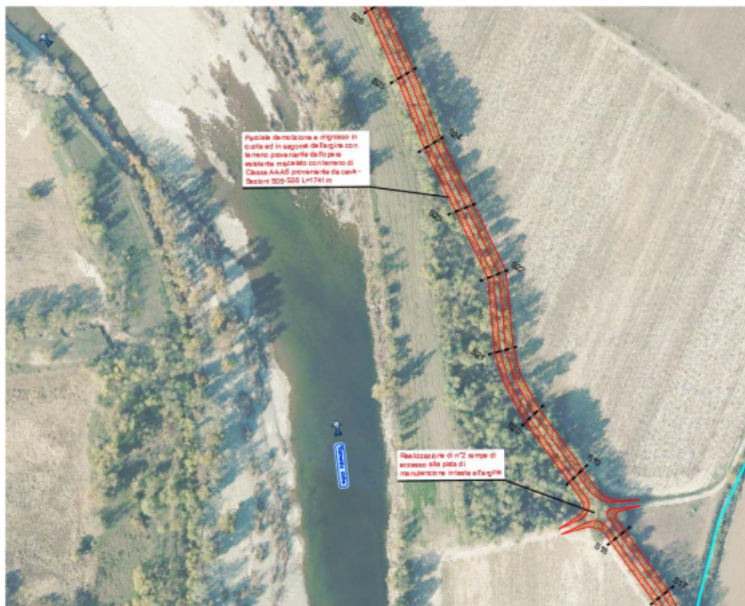
FIGURA 3-6 ESTRATTO DELLA PLANIMETRIA DI PROGETTO DELL'INTERVENTO N°1 TRA LE SEZIONI S26 ED S17
